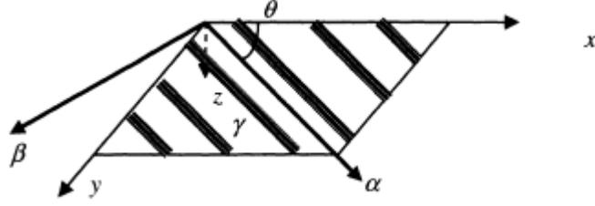
Figure : Plaque monocouche renforcée de fibres
