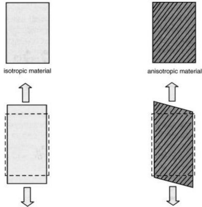
**Figure 2.1** Comparaison entre Déformation d'une plaque Isotropique et Anisotropique
