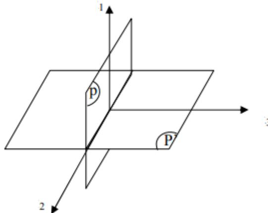
**Fig. 2.6** Plans de symétrie d'un matériau orthotrope
