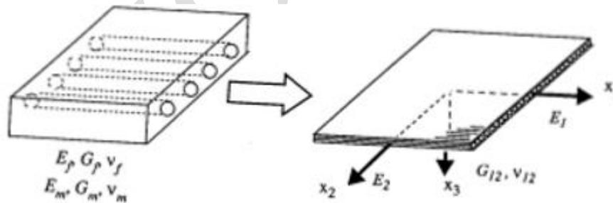
**Figure 2.2 :** Propriétés élastiques d'une couche composite renforcée de fibres unidirectionnelles
