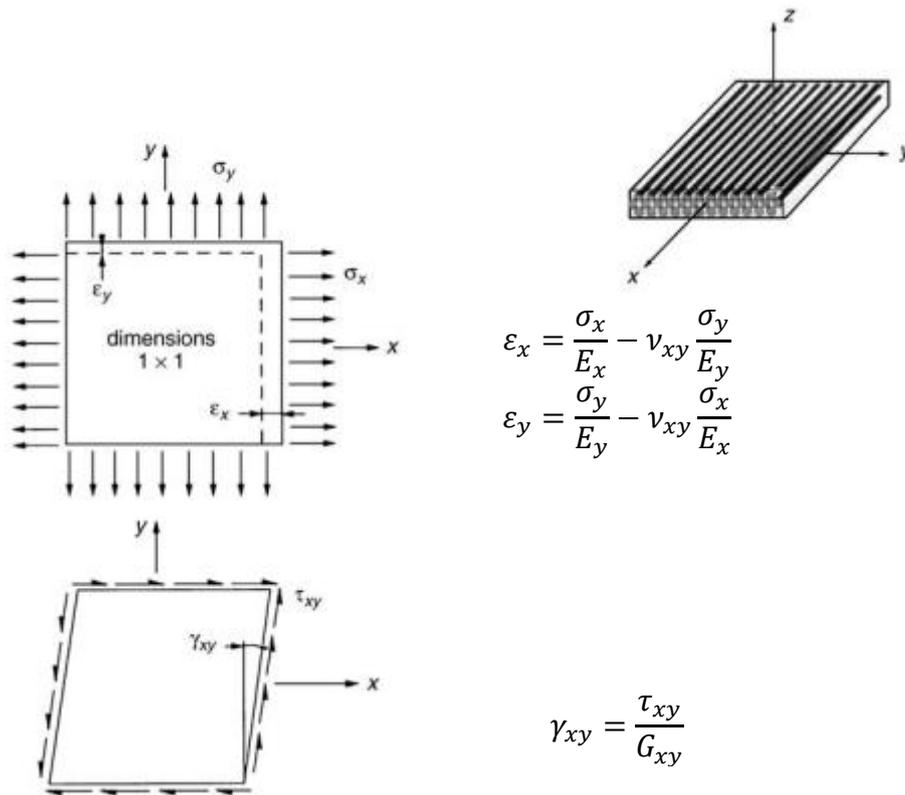
Figure 2.3 Déformation d'un matériau anisotrope
