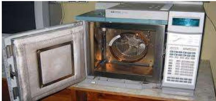
**Fig.II.1.4 : Schéma d'un appareil de CPG**
