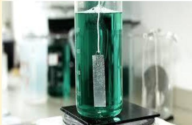
Bain de nickelage chimique au laboratoire
