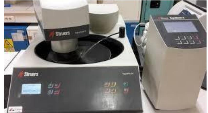
Polisseuse mécanique rotative
