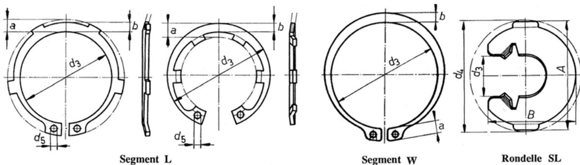
Figure 3.15: Segments d'arrêt compensant le jeu axial.
