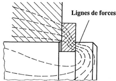
Le contrôle d'un tel assemblage utilisant s'effectuer par la vérification de la capacité de charge axiale du segment et de la gorge. Ainsi, il est parfois utile de vérifier la fréquence de rotation maximale de l'arbre afin d'assurer la fonction des segments extérieurs.
