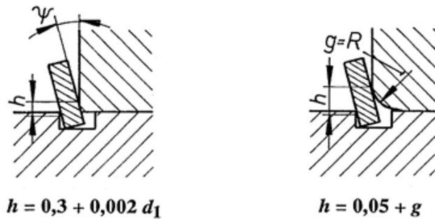
**Figure 3.19:** Angle de gauchissement admissible
