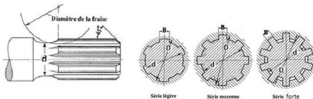
Figure 3.24: Gamme des cannelures à flancs parallèles.
