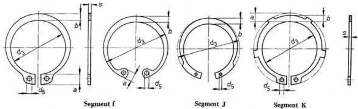
Figure 3.13: Segments d'arrêt standards.
