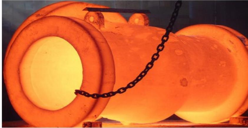
Fig. 6. Pièce ayant subi les différents types de T.T. (four horizontal peut traiter des pièces atteignant 80 tonnes et 16000x6000x5000 mm. En fonction de l'opération à effectuer sur des structures en acier classique, allié ou inox, en cuivre et en laiton) <sup>4</sup>.
