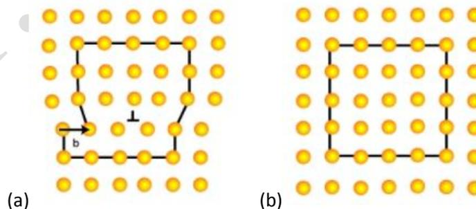
**Fig.8 :** (a) Circuit de burgers autour d'une dislocation coin avec un sens de ligne positif ; (b) le même circuit dans un cristal parfait ; l'échec de la fermeture est le vecteur Burgers.
