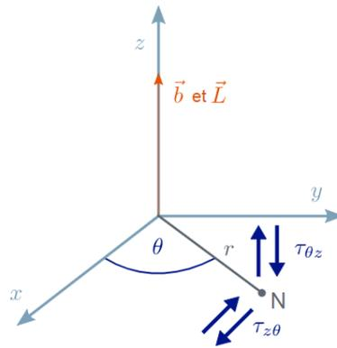
Fig. 11 Contraintes de cisaillement autour d'une dislocation vis
