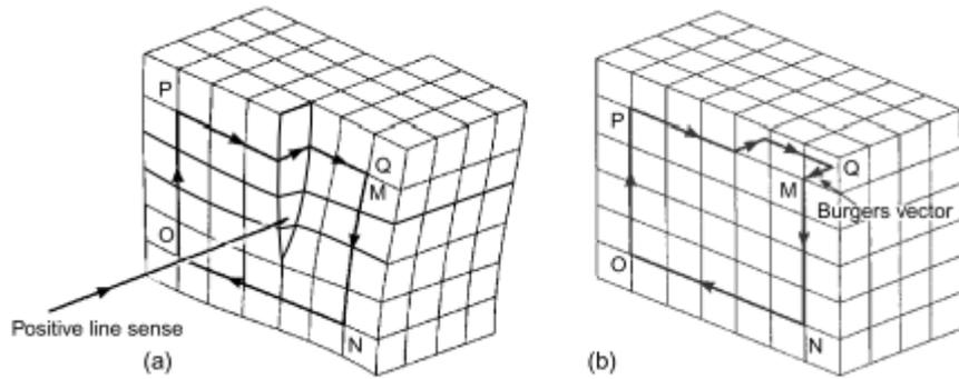
**Fig.9 :** (a) Circuit de burgers autour d'une dislocation vis à gauche avec un sens de ligne positive; (b) le même circuit dans un cristal parfait ; l'échec de la fermeture est le vecteur Burgers.
